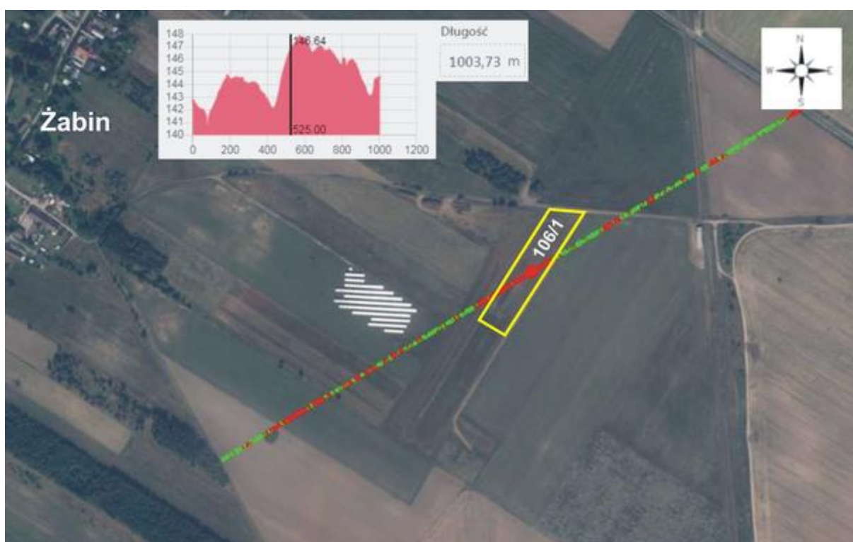
Rys. 2. Analiza profilu terenu wzdłuż zadanej linii na tle ortofotomapy
